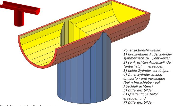
Durch Variation des Durchmessers des senkrechten Zylinders können verschiedene Formen von Dachrinnen erzeugt werden.
