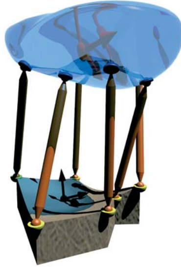
Abbildung 2.2: Eine mögliche Lösung der Vorwärtskinematik für die Angabestücke aus Abbildung 2.1
