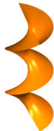
Abb. 3.78: Regelschraubfläche
