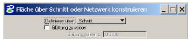
**Schnitt oder Netzwerk konstruieren**“ (Fläche modellieren, 1a,
