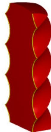
Abb. 3.74: Meridianschnitt der Schraubfläche
