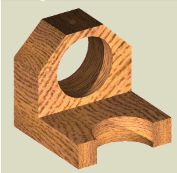
Am Objekt ist an den gekennzeichneten Positionen jeweils ein durchgehendes Bohrloch mit einem Durchmesser von 60mm anzubringen.
