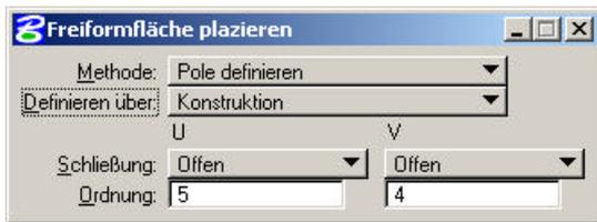
Zur Konstruktion mit MicroStation zeichnest du zuerst die vier Polygone, wählst dann das Werkzeug **Freiformfläche platzieren** (Fläche modellieren 1a-3) und klickst der Reihe nach die Polygone an.
