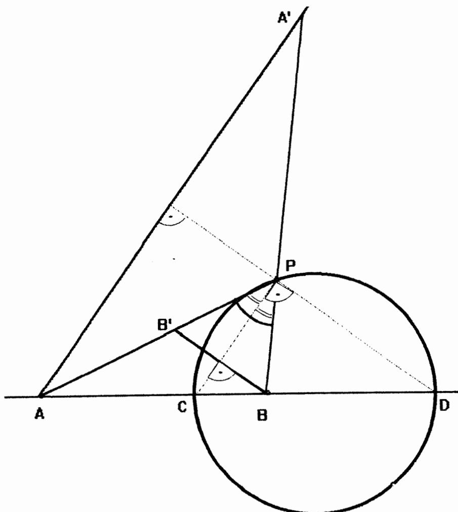
Die Winkelhalbierende des Außenwinkels eines Dreiecks teilt die gegenüberliegende Dreiecksseite *außen* im Verhältnis der anliegenden Seiten.
