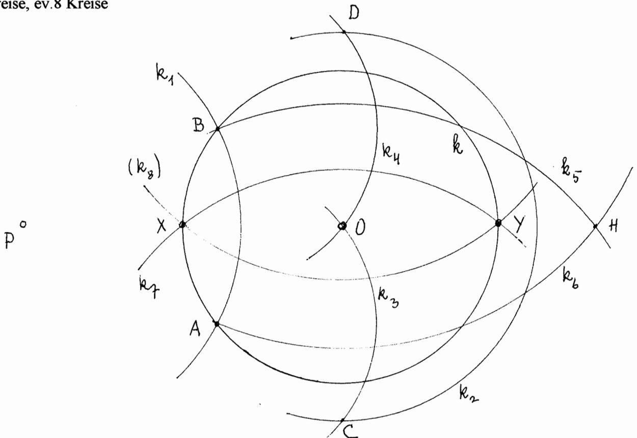
Der Radius  $\rho$  des Hilfskreises  $k_1(P,\rho)$  ist so zu wählen, daß er den gegebenen Kreis  $k$  in zwei Punkten A, B schneidet. Anschließend ist der Bogen (AB) zu halbieren (Siehe Nr. 3)
