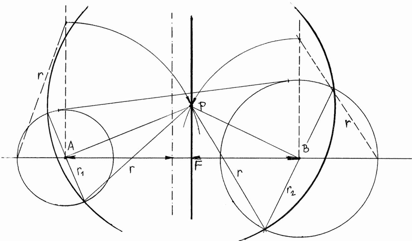
Soll der Kreis  $k(P, r)$  die beiden Kreise  $k_1(A, r_1)$ ,  $k_2(B, r_2)$  nach Gegenpunkten schneiden, so muß nach Seite 5 gelten
