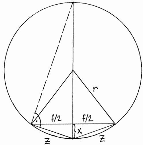
Die Konstruktion der Fünfeckseite ergibt sich daher aus obiger Figur.
