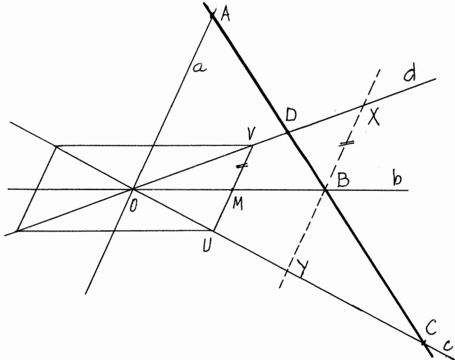
Ein harmonischer Vierstrahl durch  $O$  schneidet aus jeder nicht durch  $O$  gehenden Geraden ein harmonisches Punktequadrupel aus.
