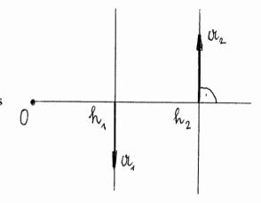
Der Betrag des Reduktionsmomentes ist also unabhängig vom Bezugspunkt. Das Moment ist demnach bezüglich jedes Punktes der Ebene gleich. In diesem Fall spricht man von einem *Drehmoment* oder gleichbedeutend von einem *Kräftepaar*.
