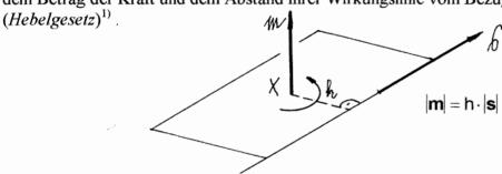
Dargestellt wird das Drehmoment durch den *Momentenvektor*, welcher auf der Verbindungsebene von Wirkungslinie und Bezugspunkt normal steht, dessen Länge gleich dem Betrag des Drehmomentes ist und der so orientiert ist, daß, von seiner Spitze aus gesehen, die Drehung um den Bezugspunkt positiven Sinn hat.
