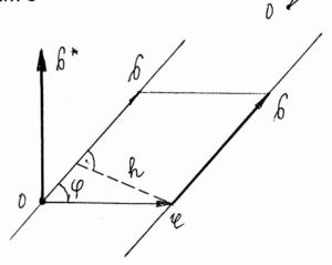
Die Trägergerade (Wirkungslinie) sei durch den Orstvektor  $\mathbf{x}$  und den Kraftvektor  $\mathbf{s}$  als Richtungsvektor gegeben. Dann gilt für den *Momentenvektor*  $\mathbf{s}^*$  um 0
