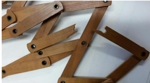
Abbildung 8: Bruchstelle des Modells zur Darstellung der affinen Transformation in der Ebene (Modell Nr. 119 im ebenen Katalog)
