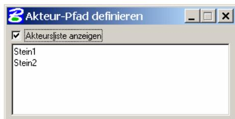
Nun geben wir die Bahn des Objektes – am besten als Konstruktionselement - vor (Linien, Kreise, B-Splinekurven, ...) und wählen das Werkzeug „Akteur-Pfad definieren“ (Animation 1a-6) aus. Im Dialogfenster wählen wir den gewünschten Akteur durch einen Doppelklick aus und klicken anschließend den Endpunkt der Bahnkurve an - Achtung der angeklickte Punkt gibt auch den Endpunkt der Animation an!
