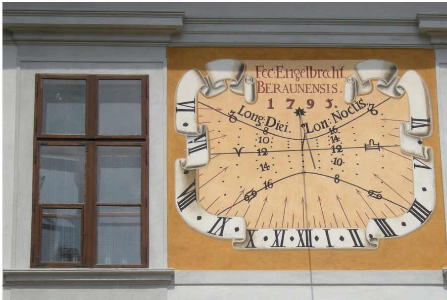
Traditionelle Sonnenuhr mit dem Zeiger parallel zur Erdachse
