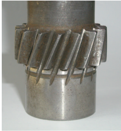
Abbildung 1: Schräg Zahnflanken zur Evolventenverzahnung
