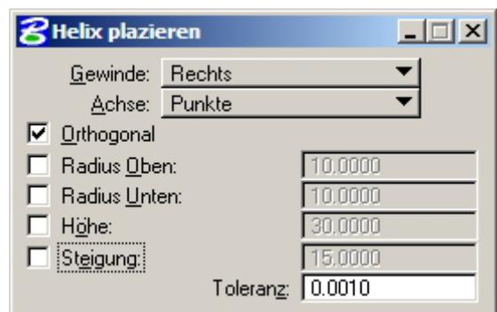
Wir zeichnen also die Schraublinie (
