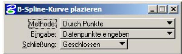
Bei der Einstellung „Durch Punkte“ kann die Ordnung der B-Spline-Kurve nicht gewählt werden. MicroStation erstellt bei der Verwendung dieses Werkzeugs stets eine Kurve dritter Ordnung. Nun snappen wir die Punkte - wie in der Skizze vorgegeben - dem Kurvenverlauf folgend, wobei der Fangfunktionsdivisor durch Drücken der Taste „k“ auf 5 gestellt sein muss. Das Programm zeichnet automatisch mit. Mit der rechten Maustaste beendet man die Eingabe von Punkten und die Kurve wird endgültig gezeichnet.
