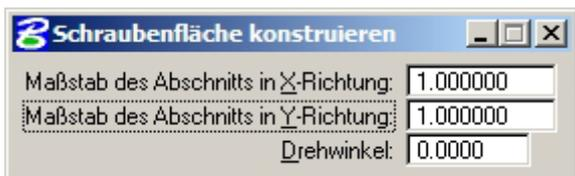
In der Toolbox „Fläche modellieren“ befindet sich die Funktion „Schraubfläche konstruieren“ (1a
